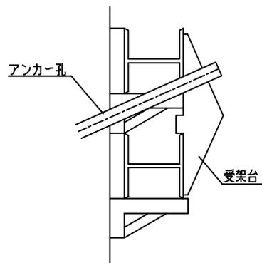
② ・アースアンカーの頭部に当板、荷重計、止め金具等を組み付ける。
